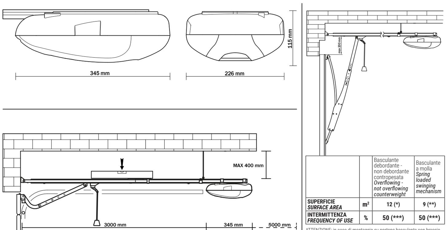
ATTENZIONE: in caso di montaggio su portone basculante con braccio oscillante (LT324) verificare che la porta sia bilanciata correttamente.
